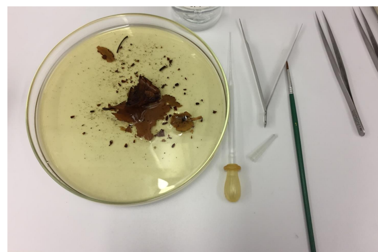
1: Laborwerkzeuge (Pinzette, Federstahlpinzette, Pinsel und Pipette)
